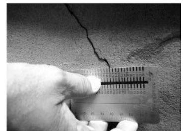
クラックスケールによるひび割れの計測
