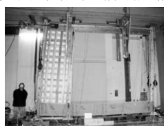
壁外側の柱脚浮き上がりが見られるが、梁の曲げ戻し効果と鉛直力により全体構面の剛体回転は保持される。
