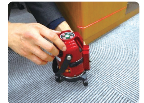
床の傾き調査(レーザー水準器)
