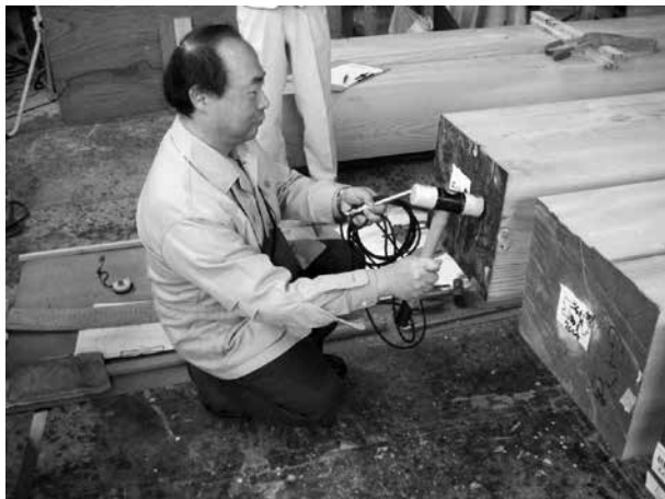
写真1 大断面製材の打撃法によるヤング係数の測定風景 スパン7mの梁のヤング係数を確認している。
