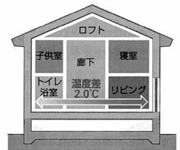
適切に断熱された住宅(外気温6.5℃)
